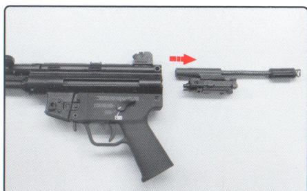
注意若要將槍機組組合回去,首先要先將下槍身分位(擊鎚下壓),否則若槍機先進入時連發桿會卡死
