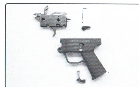
完成扳機組件取出
